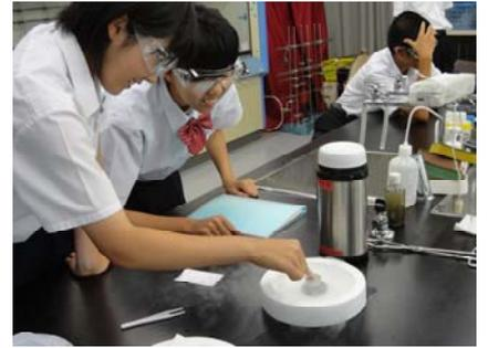
液体窒素で冷やすと、普段使っている導線でも抵抗が少なくなり、電球が明るくなる。
