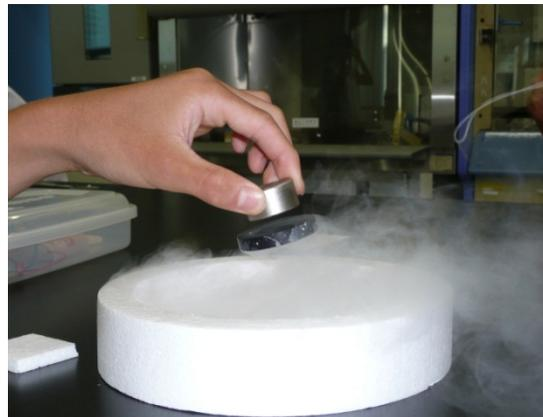
この現象は「ピン止め効果」といい，ピンで止めたような動きをするからこう呼ばれるのだそうです。超伝導体の中に含まれる不純物がネオジム磁石の磁力に反応してくっついている状態です。下の白い丸枠は発泡スチロールの皿で，この中に液体窒素を流し込んで超伝導体を冷やしています。
